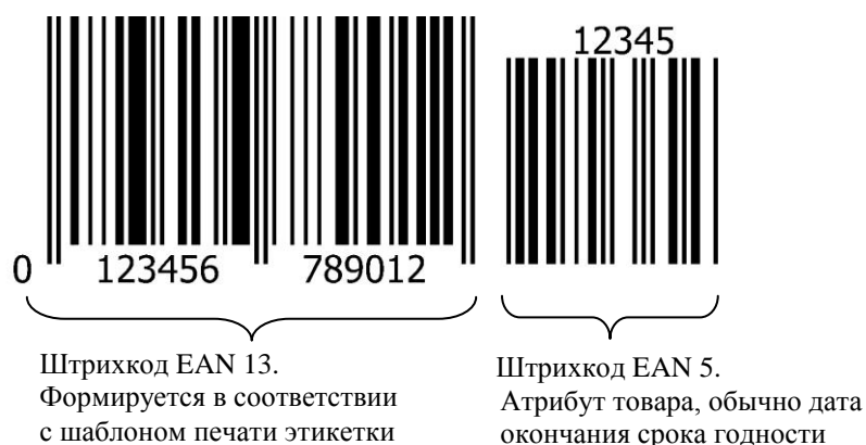
Рис. 6.2 – Структура штрихкода EAN 13+5
